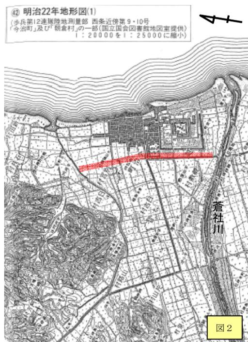
そして、明治時代を迎えます。これ（図2）は、明治22年の図面です。当時の陸地測量部、いわゆる国土地理院の図面に相当します。図の下の方の道路は条里制の道路で、上の方の道路は城下町の町割りの道路です。城下町の町割りの道路と条里制の道路は、食い違っています。条里制の道路は、海岸より少し内陸に入った田畑が多い地域の等高線に沿ってつくられています。ところが、今治城は先ほどお見せしたように、海水を引き入れて造ったお城ですので、直近の海岸線に平行になるように造られました。この内陸部の等高線と当時の海岸線が、微妙に食い違っていたので、城下町の道路の軸線と条里制の道路の軸線との違いという形で残っていました。これは実は、現在に至るまで残っています。この研修会を行っているホテルの前の道路が1つの境界でして、この道路を北に少し行くと市役所があるのですが、市役所から北側に伸びている道路が少し屈曲しています。市役所から北側については条里制の道路、市役所から南側は城下町の道路になっています。
